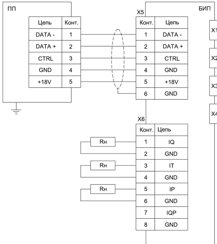
ПП – Первичный преобразователь; БИП – Блок интерфейса и питания; X1 – Разъем подключения флэш-носителя; X2 – Разъем подключения принтера; X3 – Разъем подключения RS-232; X4 – Разъем USB-B для подключения ПК через виртуальный СОМ-порт X5 – Клеммная колодка БИЗ; X6 – Клеммная колодка ТИ
