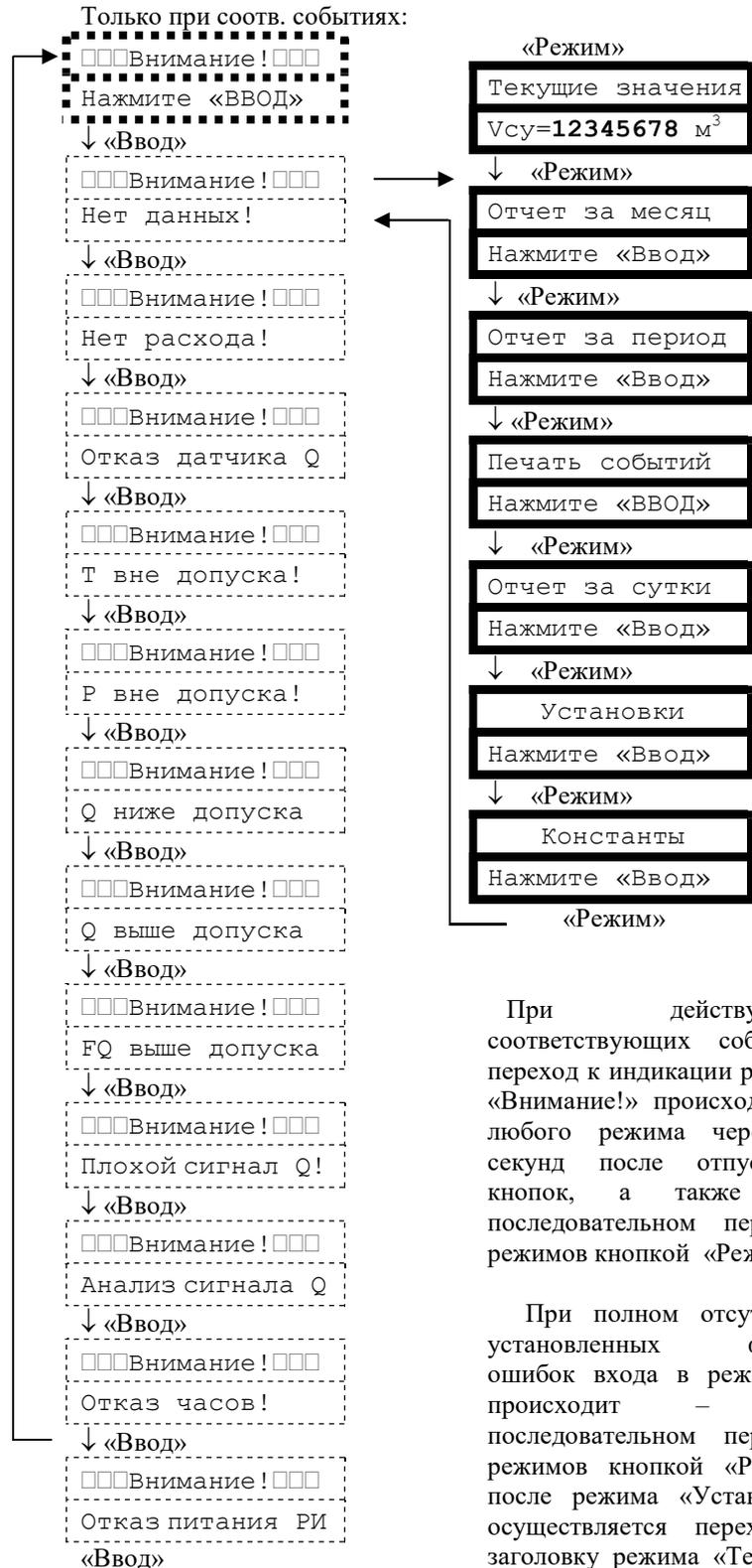
При действующих соответствующих событиях переход к индикации режима «Внимание!» происходит из любого режима через 20 секунд после отпускания кнопок, а также при последовательном переборе режимов кнопкой «Режим».
