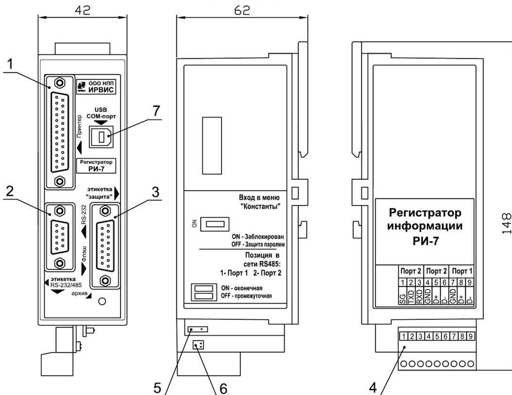
1 – Разъем LPT-порта; 2 – Разъем RS-232; 3 – Разъем для подключения флэш-носителя; 4 – вилка контактной системы; 5 – Переключатель для блокировки меню «Константы»; 6 – Переключатель для подключения резистора-терминатора для сети RS-485; 7 – Разъем для подключения ПК через виртуальный COM-порт
