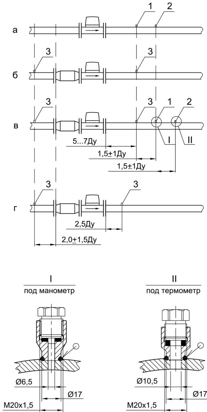
1 – Штуцер для контрольного манометра; 2 – Штуцер для контрольного термометра; 3 – Штуцер для измерения перепада давления
