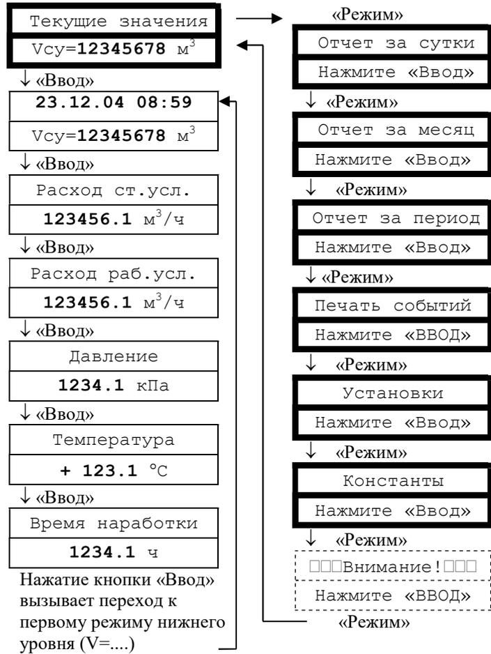
Вход в заголовок режима происходит при последовательном переборе режимов кнопкой «Режим»
