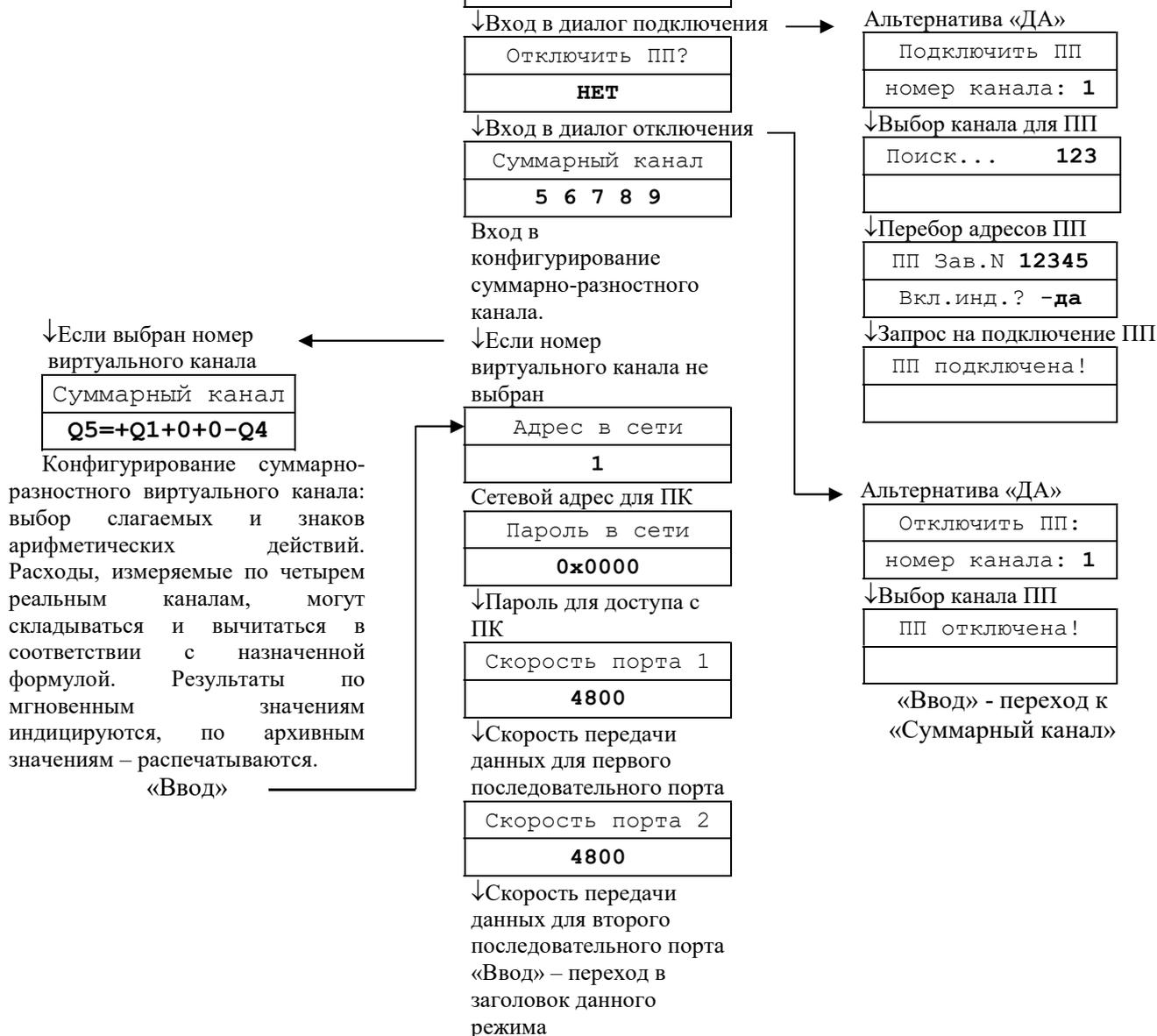
Конфигурирование суммарно-разностного виртуального канала: выбор слагаемых и знаков арифметических действий. Расходы, измеряемые по четырем реальным каналам, могут складываться и вычитаться в соответствии с назначенной формулой. Результаты по мгновенным значениям индицируются, по архивным значениям – распечатываются.
