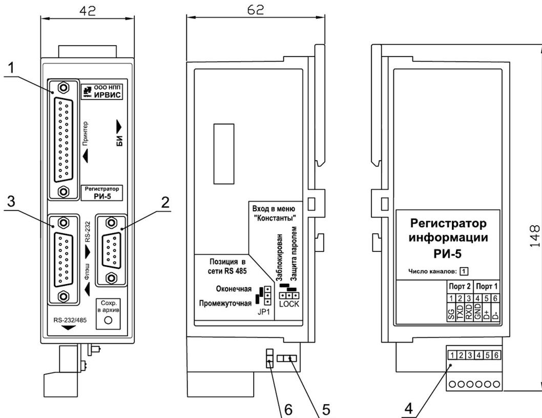
1 – Разъем LPT-порта; 2 – Разъем RS-232; 3 – Разъем для подключения флэш-носителя; 4 – вилка контактной системы; 5 – Джампер для блокировки меню «Константы»; 6 – Джампер для подключения резистора-терминатора для сети RS-485
