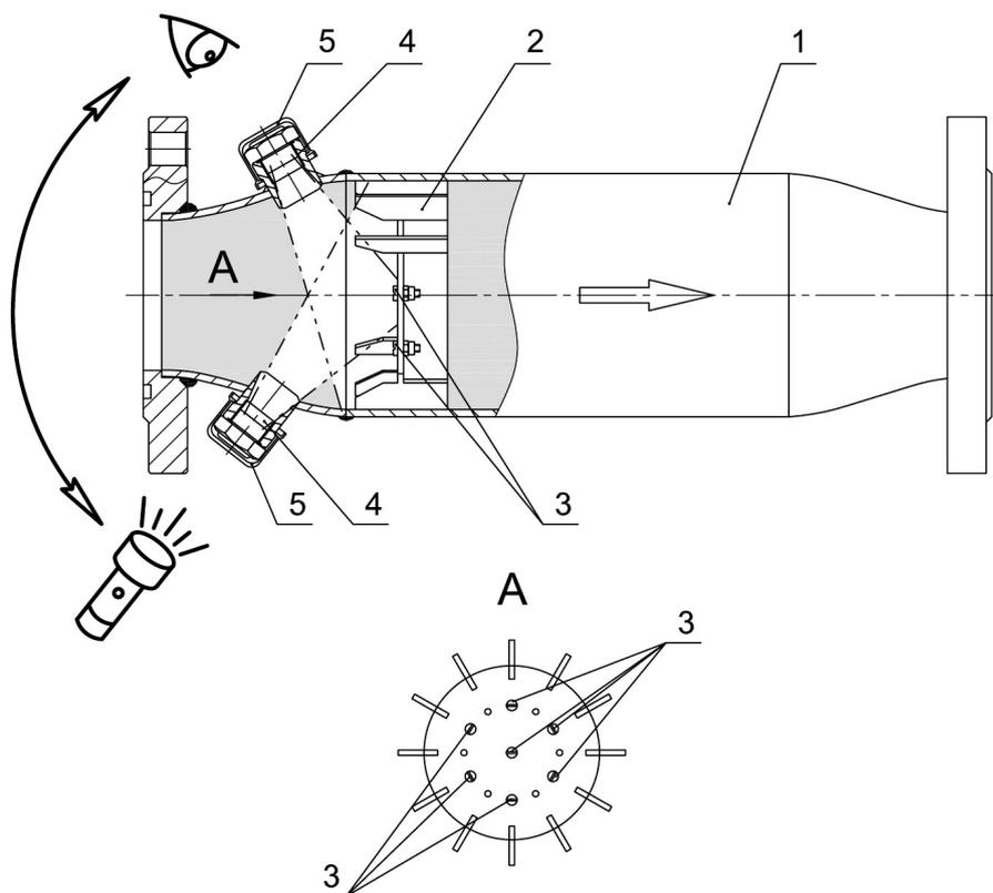
Рисунок 1 – Устройство и схема осмотра внутреннего состояния УПП
